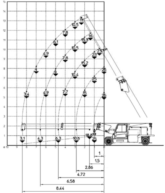
... mit hydraulischem JiB
