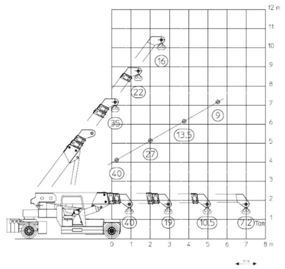
Traglasteinheit mit Jib, Antriebseinheit ausgefahren, 3 Kontergewichte
